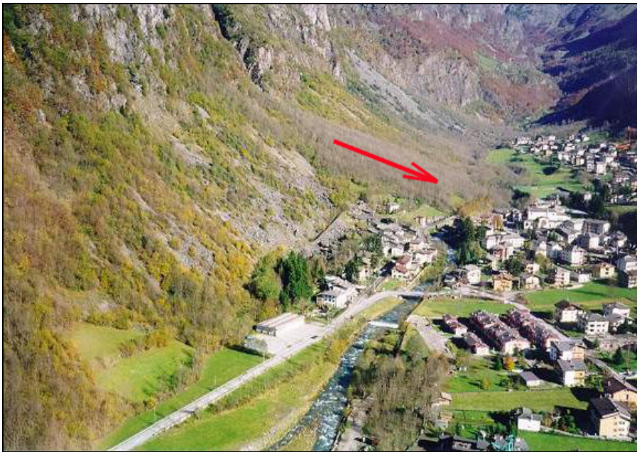
Fig. 10 – Valbondione: il corso del Fiume Serio, in questo tratto, subisce una deviazione verso la sponda sinistra a causa della presenza di un ampio cono di deiezione. I crolli, avvenuti anche recentemente, potrebbero sbarrare il corso del fiume, provocando l'inondazione delle aree ubicate in sponda sinistra.
